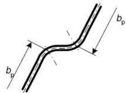
(d) ) теоретична ширина b_p плоских частин, суміжних з елементом жорсткості на стінці
